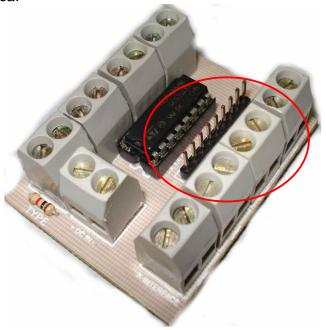
Neste conector fica conectado o cabo que deve ser conectado na porta paralela do PC para comunicar com a placa.
