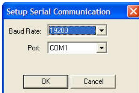
No campo Baud Rate escolha a velocidade 57600 e no campo PORT escolha a porta no qual a placa está conectada em seu PC, que normalmente é a COM1. Em seguida pressione Ok.
